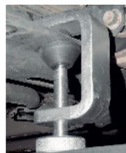
A fixação do 101518 é feita através de **dois “grampos”** que são fixados a componentes estruturais ou de suspensão, como longarinas, travessas, quadros, etc.
