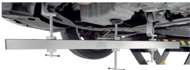
Exemplo de instalação longitudinal em um Ford Fusion.
