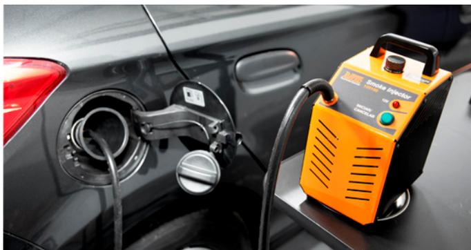
Teste de vazamentos no sistema de combustível
