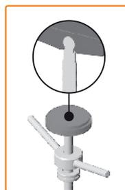
Além disso, destacam-se no 101518 três **apoios emborrachados móveis**, apoiados em esferas, que se ajustam ao formato dos componentes do veículo, além de um rolamento axial que diminui o esforço e facilita o posicionamento do apoio.
