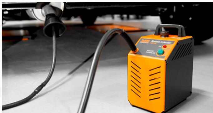
Teste de vazamentos no sistema de escape
