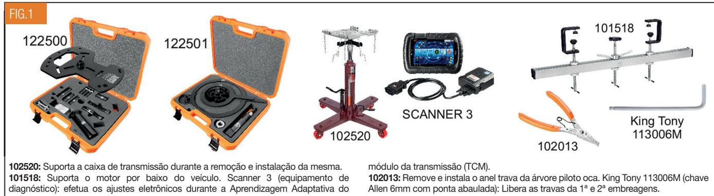
**102520:** Suporta a caixa de transmissão durante a remoção e instalação da mesma.
