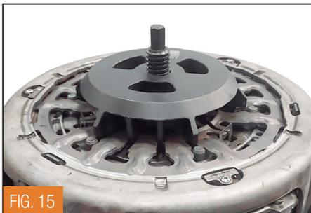
17 - Posicione a ferramenta 122501-00F na lateral da carcaça da embreagem, encaixando seus 3 dentes mais estreitos nos 3 dentes do auto-ajustador da 2ª embreagem (Fig. 16). Em seguida, gire a ferramenta 122501-00F em sentido anti-horário, o máximo possível (até que os dentes do auto-ajustador se encostem em seus batentes), e então mantenha-a nessa posição.
