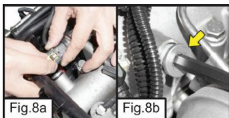
21 - Remova os buíões de acesso às árvores de comando de válvulas localizados na tampa de válvulas e paralelos ao injetor do 1º cilindro (Figs.8b e 8c).
