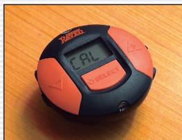
Posicione o indicador sobre uma superfície plana, ligue-o e aguarde a auto-calibração (leva cerca de 6 segundos).
