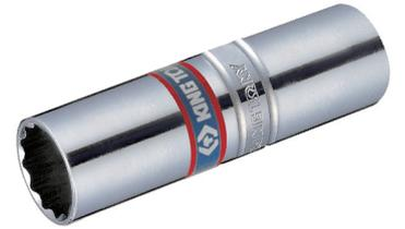
Para remover e instalar as velas dos motores Peugeot/Citroën/BMW 1.6 16V THP, aplicados no 308, 408, 508, 3008, RCZ, C4 Lounge, DS3, DS4, DS5 e em determinados BMW e Mini, utilize o soquete estriado de 14 mm com borracha e encaixe de 3/8" King Tony 36B014.
