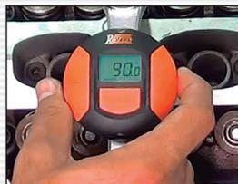
Posicione o indicador sobre a haste de uma chave fixa, estrela, cabo de força ou chave catraca com soquete.
