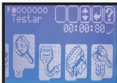
Com o Raven Scanner II selecione o módulo *Testar* e pressione "Enter".
