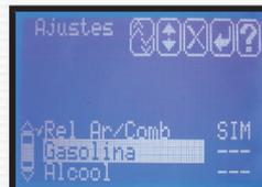
Deve haver só gasolina ou só álcool. Se houver mistura, esvazie o tanque e coloque 10 litros de um tipo de combustível. Pressione "Enter".
