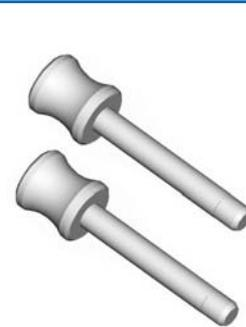
CONJUNTO COM 2 PINOS PARA POSICIONAR EM PMS OS EIXOS DO COMANDO DE VÁLVULAS DO MOTOR EA-111 (II) DO GOL POWER 1.0 16V DURANTE A TROCA DA CORREIA DENTADA.
