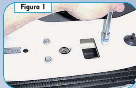
**2•** Separe a sapata de apoio do tubo do acessório 515/A;
