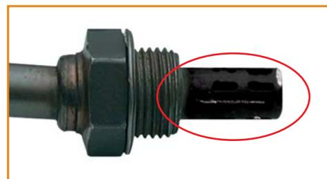
Pontas negras, carbonizadas, indicam que a mistura de combustível está muito rica ou então que o aquecedor interno está danificado. Substitua a sonda pois a carbonização afeta o tempo de resposta ao módulo de comando prejudicando o desempenho do motor.
