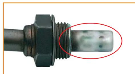
Pontas com manchas brancas ou cinza bem claro indicam combustível ruim, motor queimando óleo, problemas de assentamento das válvulas ou desgaste dos anéis dos cilindros. Elimine a possível causa e substitua a sonda.
